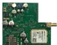
Modulo GSM per l'estensione della comunicazione del combinatore CT-BUS alla rete GSM.
