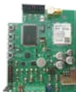
Combinatore telefonico digitale con sintesi vocale integrata per la telegestione su linea telefonica GSM delle centrali DEFENDER WEB, HYBRID WEB e DEFENDER24.
